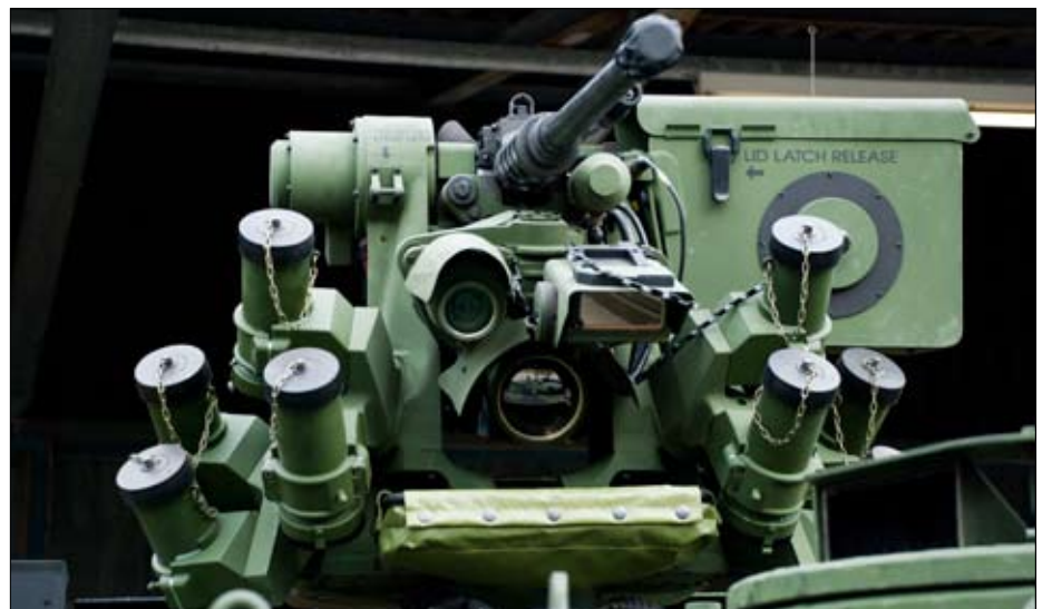
Der neue Waffenturm mit Mg, Nebelwerfern und optischen Instrumenten.
