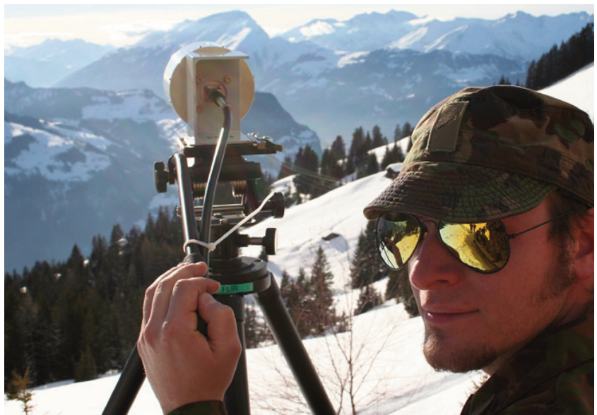
Damit die Bilder auch in der Einsatzleitung ankommen, muss die Antenne von Hand auf den Heli ausgerichtet werden.
