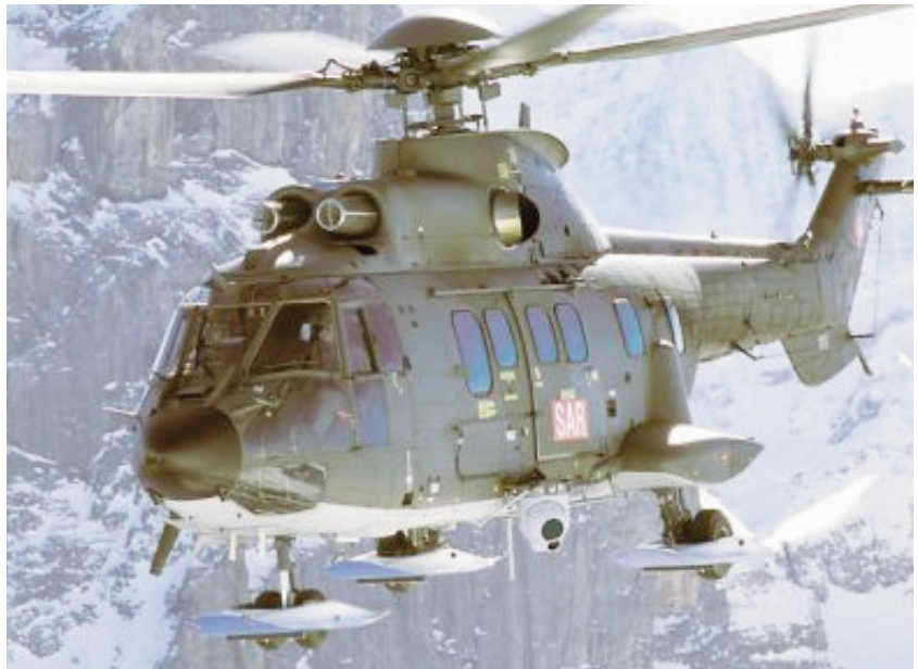
Der SAR-Heli (Search and Rescue) AS 332 Super Puma ist mit einer hochauflösenden Wärmebildkamera ausgerüstet und überträgt die Bilder an die Richtstrahl-Station. Luftwaffe
